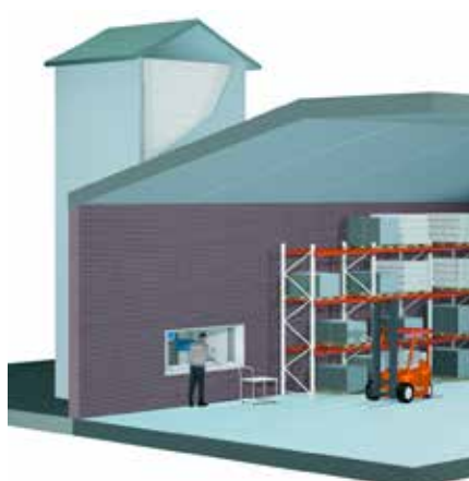
Installation utanför byggnaden med plocköppning på insidan.
